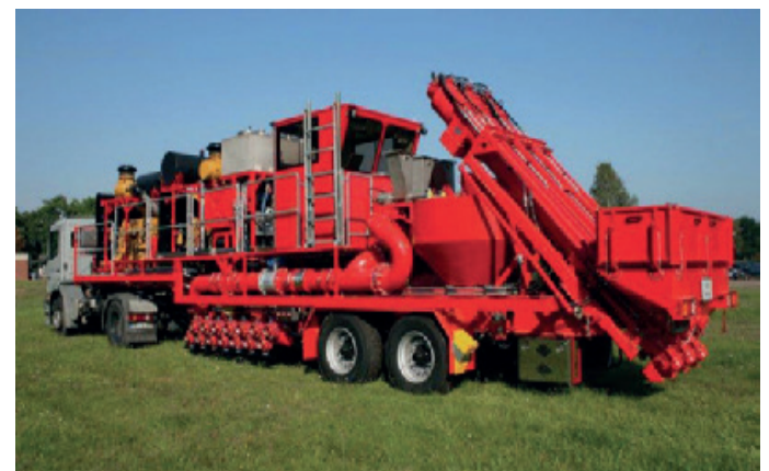
Anwendungsbeispiele: Oben: Richtbohrgerät Unten: Frac-Sand Mischfahrzeug
