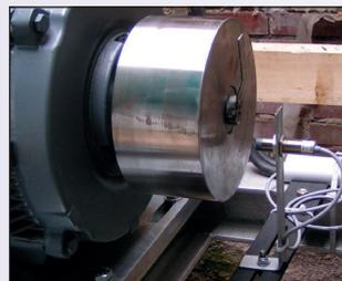
Drehzahlsensor am Generator
